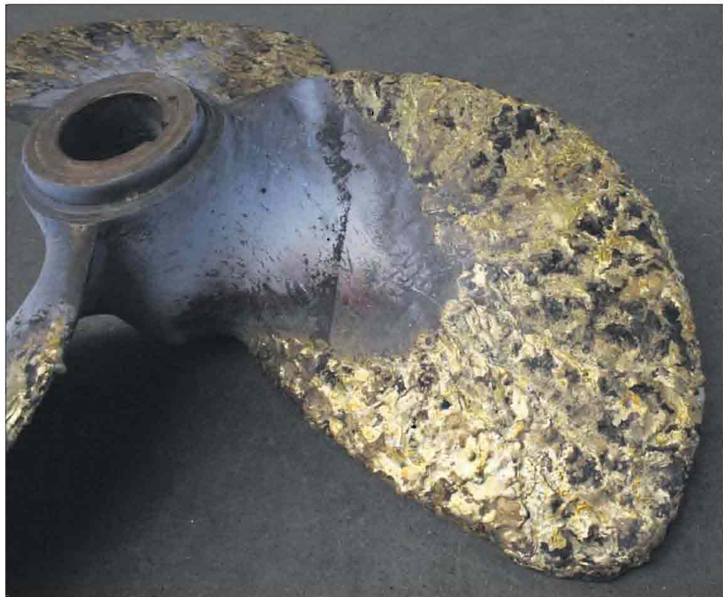
• Een opgelast blad van een schroef die bij Jooren wordt opgedikt. Na het oplassen worden de bladen geslepen, de spoed zuiver gemaakt, waarna de schroef verder wordt afgewerkt en uitgebalanceerd. (Foto's Hans Heynen)
