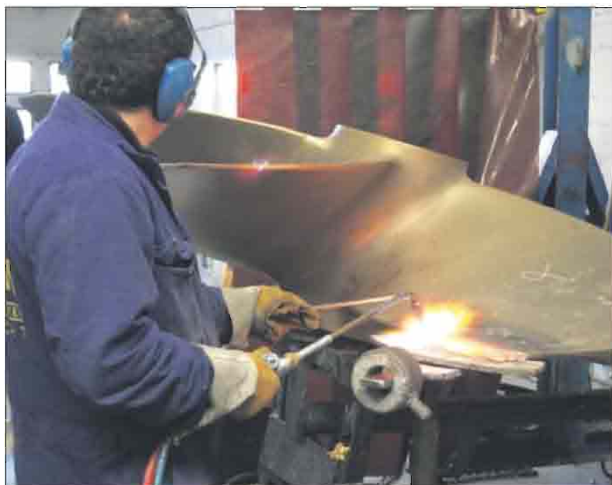
• Meesterlasser Abnan Ozcan is hier bezig met het opdikken van de schroef van een van de duwbotten van Veerhaven.
